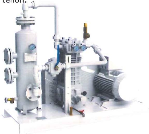
Compresseur sur socle avec pot anti envahissement liquide, manomètres, vanne 4 voies permettant l'inversion des circuits aspiration et refoulement, filtre, soupape de sûreté, carter, poulie, courroie et moteur électrique.
